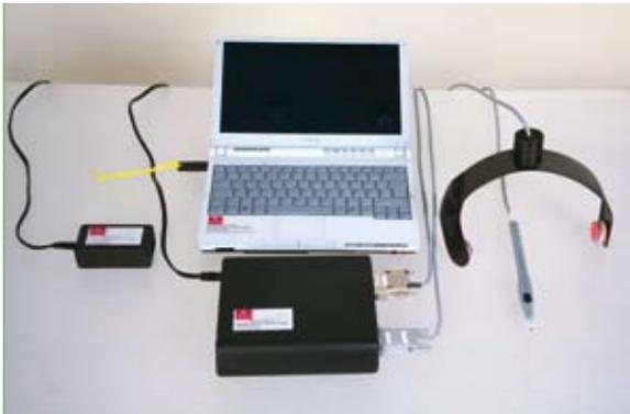
Abb. 5: Die Komponenten des noXrayCeph®-Messsystems: Karbonkappe mit GPS-System, Messstift, Scanner und Computer.
